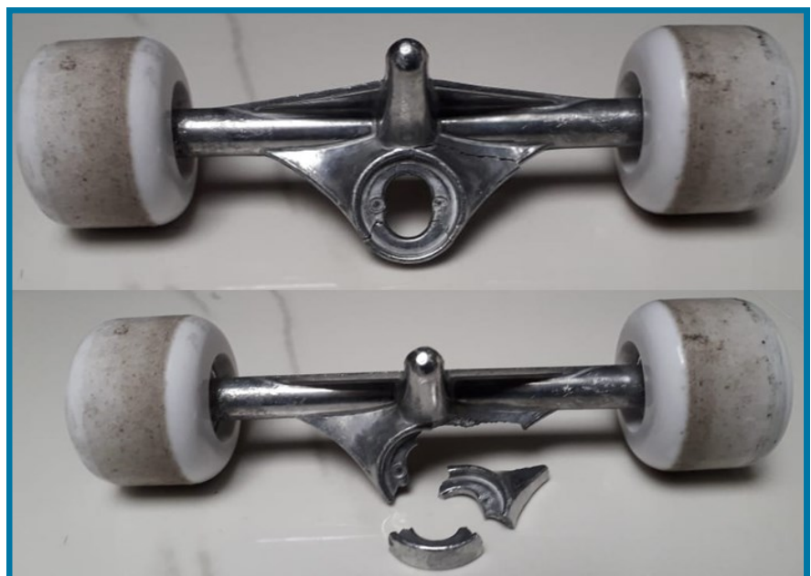
FIGURA 6. TRUCK DESPUÉS DE LA FALLA
