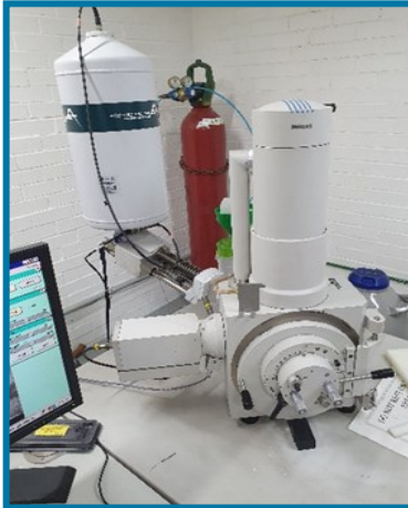
FIGURA 7. MICROSCOPIO ELÉCTRICO DE BARRIDO PHILIPS MODELO XL-20
