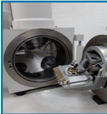
FIGURA 11. CÁMARA DE VACÍO DEL MICROSCOPIO ELÉTRÓNICO.
