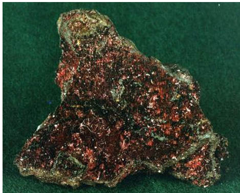
Cuprita es la forma mineral del óxido de cobre de donde se extrae el mineral
