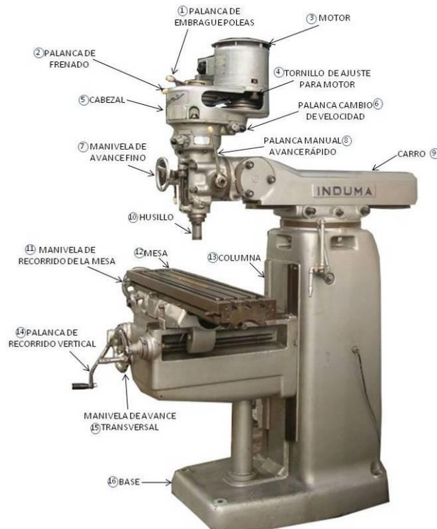
Figura 6. Partes de la Fresadora Vertical INDUMA
